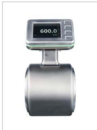
El sensor detecta el caudal actual, el volumen total y el sentido del flujo, así como la presencia del fluido. Además, la conductividad y la temperatura se transmiten al sistema de control y al nivel de IT, lo que permite reducir la necesidad de puntos de medición adicionales en la instalación.
