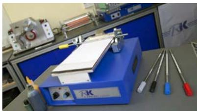
Las barras de aplicación del K Control Coater son una solución sencilla y eficaz para aplicar revestimientos precisos en la mayoría de los sustratos. Las barras de bobinado cerrado permiten obtener espesores de recubrimiento de entre 4 y 120  $\mu\text{m}$ , mientras que, utilizando barras enrolladas en espiral, se pueden alcanzar espesores de hasta 500  $\mu\text{m}$ .
