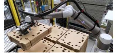
Inser Robótica S.A. reconoció la necesidad de la carga automática de montadores de cajas. Desarrollaron una solución de célula robótica colaborativa, Coboloader, que ayudó a mejorar la eficiencia de final de línea y la seguridad con los robots colaborativos de Omron.
