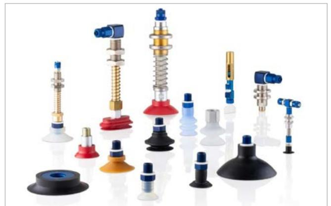
El funcionamiento de estos componentes se basa en la presencia de un generador de vacío que, mediante la creación de una concavidad en el interior de la ventosa, permite que esta se adhiera a la superficie de la pieza que se desea mover. La sujeción de la carga perdura mientras haya vacío en el sistema.
