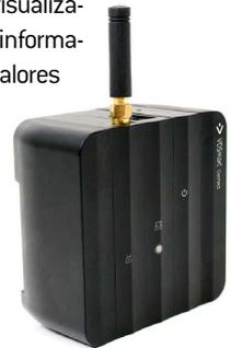
Mediante VDSmart es posible realizar un reset de fallo remoto, el cambio de consigna o la visualización de errores tras recibir una alerta mediante SMS sin estar presencialmente junto al equipo.
