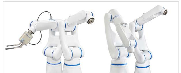
La máxima clase de protección IP69K y una superficie especialmente lisa (rugosidad superficial  $<\langle > 0,8 \text{ Ra}$ ) minimizan la adherencia de partículas de suciedad y microorganismos.
