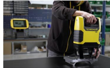
Son máquinas totalmente portátiles gracias a la comunicación inalámbrica entre el cabezal de marcado y la unidad de control. Son ergonómicas, ligeras y fáciles de manejar gracias a su mango en el eje, su manejabilidad y el software de pilotaje sencillo y completo. Tienen una potente batería integrada de nueva generación que permite trabajar con ellas en tres velocidades distintas y con una durabilidad muy elevada.
