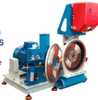
La máquina micronizadora está diseñada para pulverizar diversos productos como perfiles, tuberías, productos de extrusión, películas, materias primas granulares, cauchos utilizados en la industria del plástico, así como muchos productos diferentes utilizados en las industrias alimentaria, química y farmacéutica en polvo de tamaño micrométrico.
