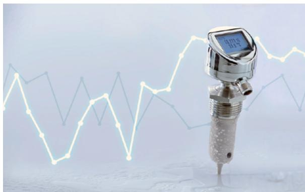
El PAC50 ofrece un rendimiento fiable incluso a temperaturas de hasta 140 grados centígrados. Y gracias a la punta del sensor, fabricada íntegramente en plástico de alto rendimiento de poliéter éter cetona (PEEK), también es extremadamente resistente a los productos químicos.
