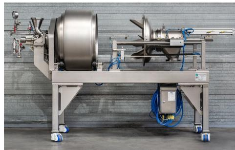
Lindor Capsule es la solución que permite secar en vacío y recubrir productos usando una sola máquina. También se puede optar por solo secar en vacío o solo recubrir, según sus necesidades.
