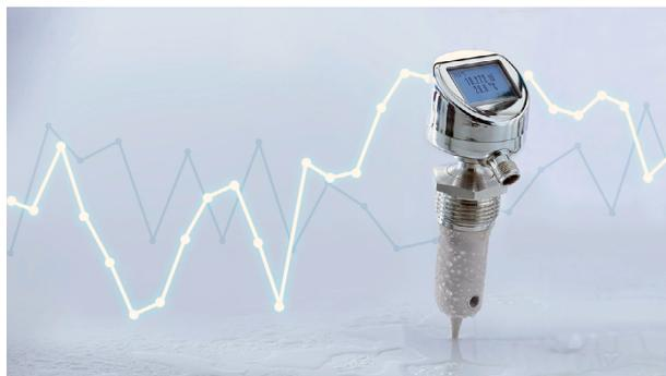
de temperatura que los sensores con punta de dos piezas. El PAC50 ofrece un rendimiento fiable incluso a temperaturas de hasta 140 grados centígrados. Y gracias a la punta del sensor, fabricada íntegramente en plástico de alto rendimiento de poliéter éter cetona (PEEK), también es extremadamente resistente a los productos químicos.
