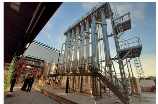
Equipo diseñado para fabricar zumos de uva azufrados, pudiendo obtener zumo de uva concentrado con las más estrictas normas de calidad y con mínimos gastos de proceso, así como mostos concentrados adecuados a los parámetros de calidad exigidos por los clientes [contenidos variables de: SO<sub>2</sub>, HMF, °Brix y THK].
