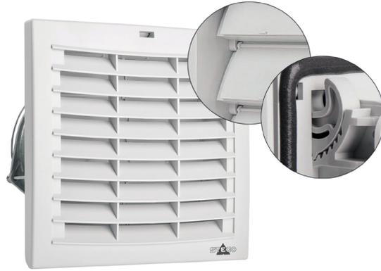
El sistema FPI (dirección del flujo de aire "in") es una instalación estándar de un ventilador con filtro y con manta filtrante en la parte inferior de la envolvente, asegurando la introducción del aire frío y expulsando el aire caliente hacia el exterior a través de un filtro de salida con tecnología "air-flap".
