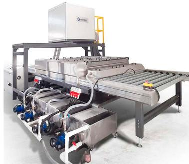
Lavadoras horizontales Vetrotec pensadas para máxima calidad de lavado y secado, máxima velocidad, puede trabajar vidrios para cualquier capa actual del mercado, con anchura desde 1.000 mm, 1.700 mm, 2.000 mm, 2.500 mm y 3.000 mm.
