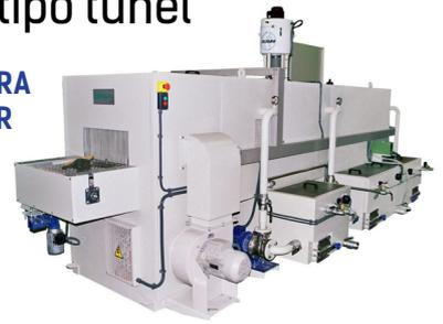
Bautermic, S.A. fabrica diversos modelos de máquinas para lavar, desengrasar, decapar, pasivar, fosfatar y secar todo tipo de piezas en continuo.
