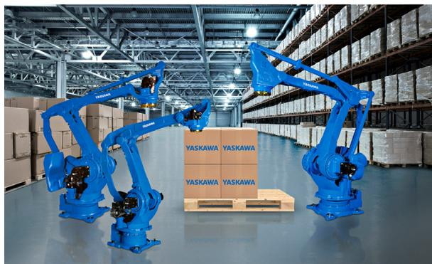
Motoman garantizan un uso óptimo del espacio para la instalación de células de paletización compactas. Los paquetes de cables para las pinzas pueden conectarse -protegidos y sin colisiones- a través de la base del robot y dentro del brazo a través de todos los ejes y la muñeca hueca. El eje hueco tiene unas dimensiones óptimas de 75 mm (PL190/320) y 100 mm (PL500/800) respectivamente.
