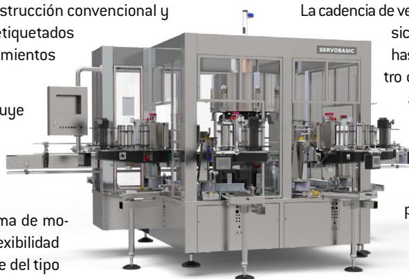
La cadencia de velocidad en los modelos Basic Y Servobasic, pueden alcanzar velocidades de 5.000 hasta 20.000 b/h dependiendo del diámetro de mesa y cantidad de platos que se le asignen. En el apartado cinemático, integra coronas conectadas entre sí de elevadísima calidad, transmisiones mecánicas sumergidas con aceite para prolongar la vida todos los componentes de rodadura.
