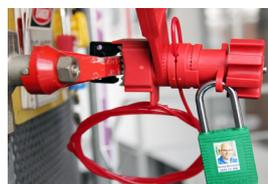
A menudo un candado de bloqueo/etiquetado es el último obstáculo para evitar una activación prematura de la máquina y un accidente de mantenimiento potencial con un impacto sobre los profesionales y su integridad física. Para destacar con
