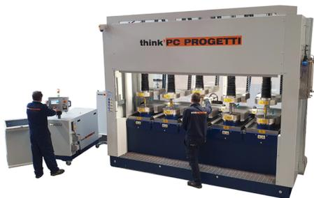
El modelo BV-5CV/400SH es un banco de pruebas con 5 estaciones de test, cada una de las estaciones tiene 80T de fuerza de reacción. El amarre combinado permite al operario elegir entre un amarre por presión proporcional y un amarre radial interno, según necesidad. El carenado completo del banco de pruebas garantiza la seguridad completa durante la prueba. La protección se puede abrir en unas condiciones específicas de seguridad para realizar la inspección visual durante la prueba.
