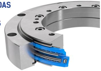
Las coronas Franke tipo LVG son coronas de giro de aluminio, diseñadas con doble hilera angular de rodillos como rodamiento interno.
