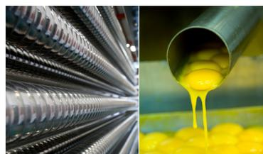
Muchos fabricantes han utilizado intercambiadores de calor de placas para pasteurizar derivados de huevo, pero estos favorecen la coagulación del producto en la superficie de la placa, ensuciando el intercambiador de calor, por lo que se necesita una limpieza 'in situ' frecuente (CIP) para mantener la eficiencia operativa, lo que supone más tiempo, energía y coste al procesamiento, y reduce la capacidad general.
