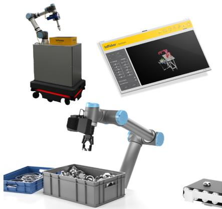
InPicker es compatible con múltiples tecnologías de análisis de imagen y visión artificial 2D/3D. El software ofrece un asistente de configuración intuitivo y una herramienta de calibración automática, lo que simplifica la gestión del proceso para los usuarios sin experiencia en visión artificial.
