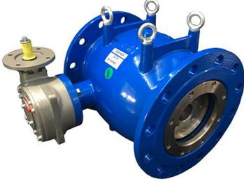
La válvula de paso anular fabricada en la planta industrial de Saint-Gobain PAM en Lavis (Italia), es la idónea en aplicaciones de regulación y control, tanto de presión como de caudal, en los sectores del mercado de agua potable y riego. Su diseño hidrodinámico y cuerpo compacto de una sola pieza, permiten grandes caudales de paso en la válvula, generando mínimas pérdidas de carga, a la vez que puede adaptarse a las necesidades operacionales del sistema.
