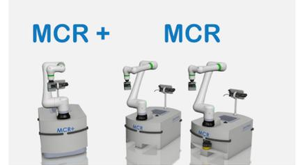
experiencia, cuenta con el robot colaborativo de Fanuc, el modelo CRX, disponible en dos tamaños (CRX-10iA y CRX-10iA/L) con un alcance 1249 y 1418 mm respectivamente y una capacidad de carga de 10 kilos lo que le convierte en un robot muy versátil.
