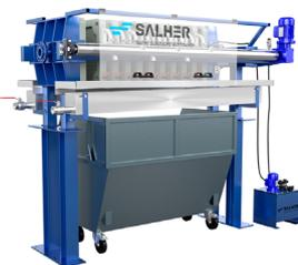
El Filtro Prensa (FP) es un equipo de Salher completamente automatizado para la eliminación y deshidratación de los fangos procedentes de depuradoras de pequeña y mediana capacidad. El principio de deshidratación mediante presión permite alcanzar mejores porcentajes de sequedad que empleando otros sistemas de deshidratación (con resultados cercanos al 30%, pudiendo ser superiores mediante el correcto acondicionamiento del fango).
