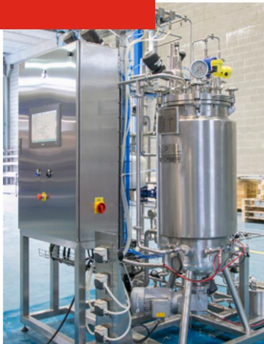
Bioreactor automatizado con software de control y SCADA
