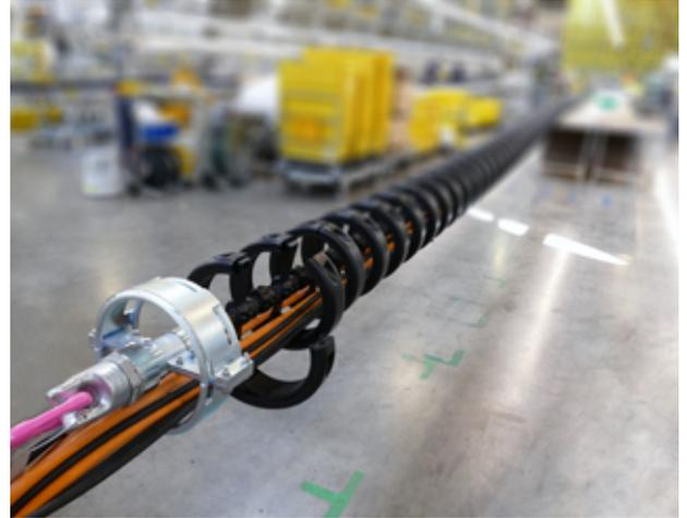
Cuando se realiza el mantenimiento o reparación del cable de perforación, es necesario reemplazar el sistema completo, ya que los cables están sellados entre sí.
