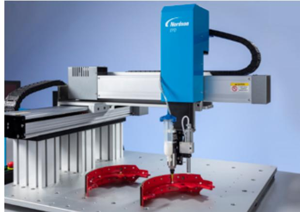
Otros beneficios del sistema incluyen la precisión del posicionamiento dimensional líder en el mercado y la capacidad de repetir la colocación de los depósitos a +/- 0,02 mm con el robot de pórtico de 400 mm y +/- 0,01 mm con el robot de pórtico de 800 mm.
