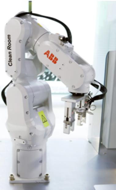
Las características clave incluyen pintura higiénica y un cuerpo sellado para evitar fugas de contaminantes como grasa, aceite y partículas, junto con un diseño mecánico que minimiza los espacios entre las articulaciones del robot para desalentar el crecimiento de bacterias.
