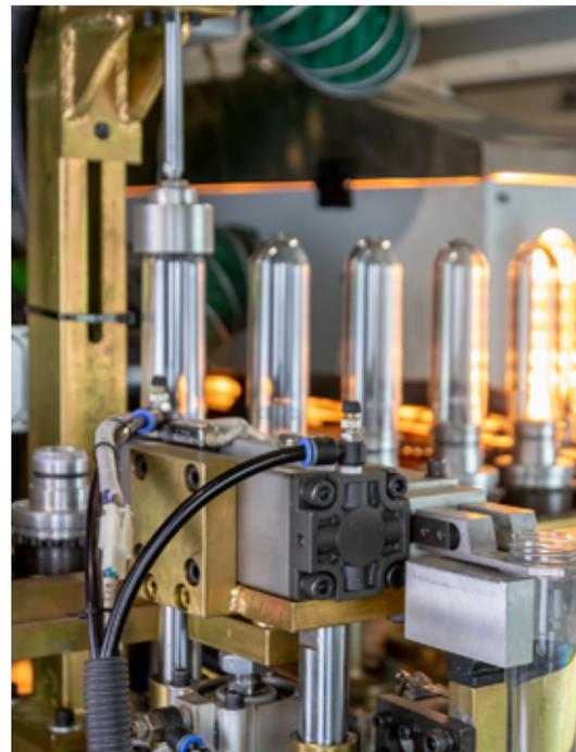
Fabricación de botellas de plástico (moldeo por soplado)
