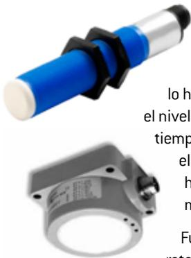
Son aparatos que funcionan a través de la propagación de ondas de alta frecuencia mediante el aire. Este fenómeno lo han aprovechado para medir el nivel de un líquido, calculando el tiempo que tarda la onda desde el momento que se ha emitido hasta que se recibe nuevamente en forma de eco.
