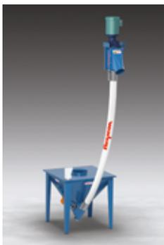
Flexicon ha presentado un transportador de tornillo flexible 1450 modelo básico con tubo de polímero de 115 mm de diámetro exterior y tolva y adaptador de descarga de acero al carbono de bajo costo. Se ofrecen tornillos flexibles redondos, cuadrados, planos o biselados de cualquier longitud de 3 a 12 m para transportar prácticamente cualquier material a granel que
