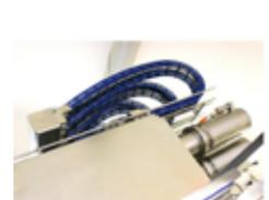
Aplicaciones típicas: máquinas de envasado, máquinas para el procesamiento de alimentos, máquinas para el llenado de bebidas y donde se requiera una máxima higiene junto con un guiado de cables y mangueras seguro.
