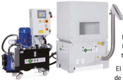
En su gama de máquinas, la empresa Maquinaria de Producción Europea S.L. (M.P.E.) tiene una solución para el tratamiento de la viruta industrial procedente de máquinas herramientas que mecanizan acero, aluminio, fundición, plástico: las compactadoras/briquetadoras Ivonne.
