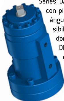
Serie DA H 20 tamaños de 36 a 250.000 Nm con pistones de diámetro Ø 40- Ø 450 mm. 4 ángulos rotativos 90°, 180°, 270° y 360° (posibilidad ángulos intermedios). Eje del actuador con 2 chavetas o eje estriado según o DIN5480. Opción de amortiguamiento, eje de levas, proximity switch, encoder.
