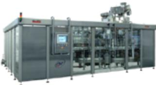
El depósito de la llenadora puede soportar una presión de trabajo de 6 bares, a pesar de haber sido ensayada hasta una presión de 9 bares.
