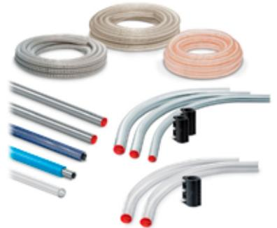
Para el transporte de polvo y gránulos de plástico existen diferentes soluciones de curvas con varios radios de curvatura. La versión antidesgaste puede transportar material con hasta un 40% de fibra de vidrio con 5 años de garantía. Las curvas para el transporte de gránulos se realizan en acero curvado con núcleo y se tratan internamente con lavado ultrasónico. Las versiones en Pyrex están disponibles.
