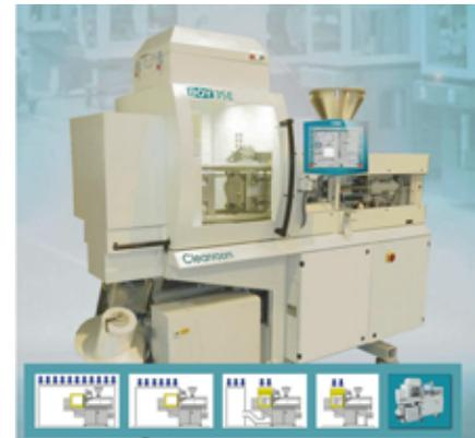
Con tecnología híbrida, hasta 125 toneladas de fuerza de cierre y con movimientos de inyección y dosificación que se realizan electromecánicamente por dos servomotores y un preciso control a través del microprocesador Procan Alpha 4.
