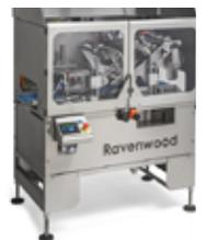
Velocidad máxima hasta 100 ppm y una gran versatilidad para trabajar distintos tipos de etiquetas y combinaciones de etiquetado, C-WRAP, D-WRAP, superior, inferior, ambos, etc.
