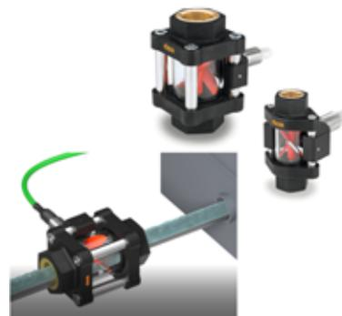
El sensor inductivo, separado por completo de la zona de paso del líquido y reemplazable en caso de avería, detecta el paso de los dos clips de acero inoxidable, montados sobre el rotor, y envía una señal a un PLC mediante una salida PNP. La precisión y repetibilidad de la medición es de  $\pm 3\%$ .
