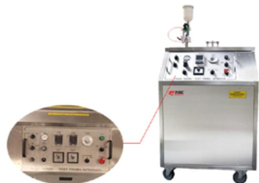
Todos los modelos se suministran, de serie, con soportes para paneles magnéticos. De forma opcional, se puede solicitar a fábrica bajo pedido un soporte de paneles por vacío para su uso con paneles planos no magnéticos.
