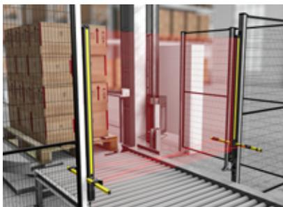
Con la ayuda del Muting, se puede instalar un equipo de protección de modo que el material se transporte de forma segura dentro y fuera de la zona de peligro. Cuatro modos de operación inteligentes ofrecen el concepto de seguridad
