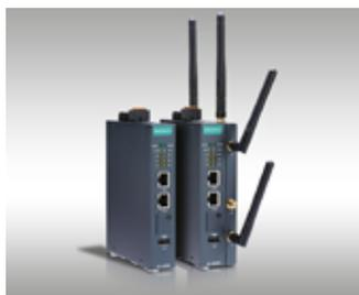
1 puerto CAN así como mPCIe dual y dos ranuras SIM que soportan conectividad redundante Wi-Fi/móvil para que los usuarios puedan instalar el UC-8200 de forma eficiente en diferentes escenarios complejos de conectividad en aplicaciones IIoT.
