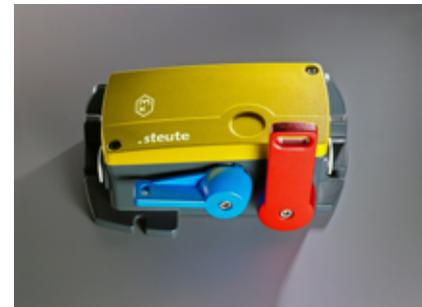
El ajuste muy sencillo del punto de activación en pasos de 5° (de 5° a 35° para dos elementos de conmutación) también aumenta la flexibilidad del Ex ZS 92 SR en la práctica. Las dimensiones de conexión compatibles tanto con la serie predecesora Ex ZS 90 como con otros interruptores de desplazamiento espontáneo de cinta e interruptores de emergencia accionados por cable simplifican el reequipamiento de la serie en sistemas (transportadores) existentes.
