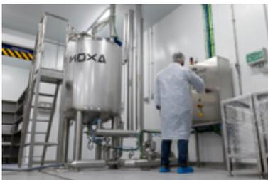
Sagafluid ofrece unidades CIP automáticas y el suministro de todos sus elementos. Desde los depósitos dimensionados en función de sus necesidades, hasta los cuadros de control con la programación en un Scada, pasando por toda la instalación de tubería, bombas y valvulería. Un sistema de limpieza CIP
