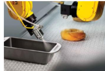
Este sistema de pulverización con tecnología robótica integrada consiste en una boquilla automática de pulverización por micropulsos, un controlador Autojet, un robot con sistema de visión y un transportador. Los componentes exactos variarán en función de la aplicación requerida.
