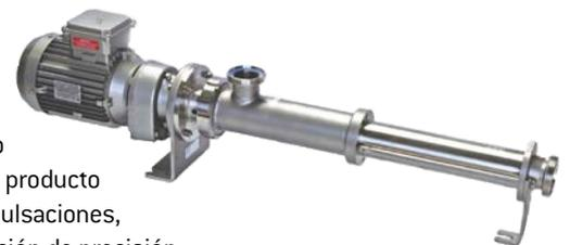
Dosificación mediante sistema volumétrico. Dosificación sin pistones evitando cizallamiento y presiones de fluidos. Dosificaciones de 0,001 ml a 4 litros minuto. Viscosidades hasta 7.000.000 cps. Compatibles con FDA. Certificado EHEDG. Libre de pulsaciones. De -20 grados a 120 grados. Mínimas rugosidades en superficie de contacto.
