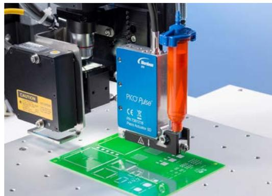
La válvula Pico Pulse y el controlador Pico Touch de EFD hacen que sea posible dosificar micro cantidades muy exactas y repetibles desde solo 0,5 nL hasta 500 Hz continuos, con inyecciones máximas de 1.500 Hz. El diseño modular de la válvula dosificadora de fluidos sin contacto Pico Pulse hace que sea posible inyectar fluidos de baja hasta alta viscosidad sobre cualquier superficie, incluso sobre sustratos irregulares y de difícil acceso.
