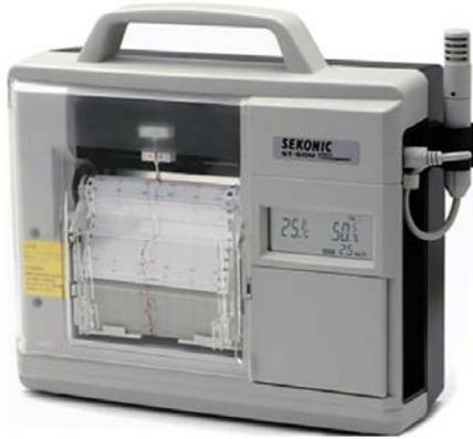
Este termohigrógrafo se utiliza para la medida y registro de la humedad y temperatura ambiente de laboratorios, áreas de maquinaria de precisión, sala de calibración, procesos farmacéuticos y alimentarios, pinacotecas, museos, y allí donde por exigencia de las normas ISO 9000 o por el tipo de objetos expuestos o almacenados sea necesario la medición y registro sistemático.
