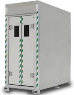
Los filtros de retorno son del tipo Hepa y, a continuación, un filtro garantiza la eliminación del máximo de partículas contaminantes de la ropa del trabajador. La limpieza se efectúa mediante 16 toberas direccionables que soplan aproximadamente 20 m<sup>3</sup>/seg de aire limpio. Interior con luminarias de LED y paro de emergencia. Programa completo automático de limpieza programable.
