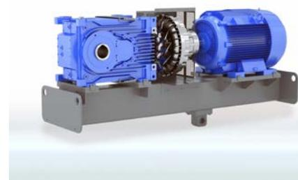
Como estándar, la serie está equipada con una carcasa Unicase muy estriada y un ventilador axial integrado. Debido al aumento de la superficie y el acanalado de las cubiertas, el flujo de aire de refrigeración se optimiza y se logra un límite térmico de la potencia muy alto. En muchos casos, no se requiere enfriamiento adicional. Los rodamientos de rodillos grandes y las mayores distancias entre centros aumentan la capacidad de carga y la vida útil de los componentes.
