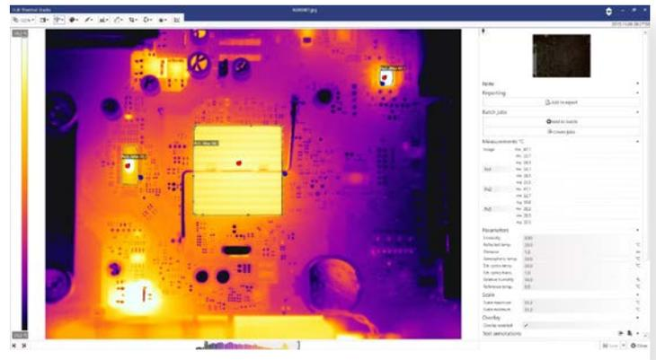
FLIR Thermal Studio es un software de análisis de imágenes térmicas y elaboración de informes para gestionar grandes conjuntos de imágenes y vídeos térmicos. FLIR Thermal Studio se ha creado para termografistas que utilizan cámaras térmicas de mano FLIR, cámaras de detección óptica de gas (OGI) y sistemas de aeronaves no tripulados (UAS), y sus capacidades de procesamiento avanzado y su automatización se han diseñado para racionalizar el flujo de trabajo y para aumentar la productividad.
