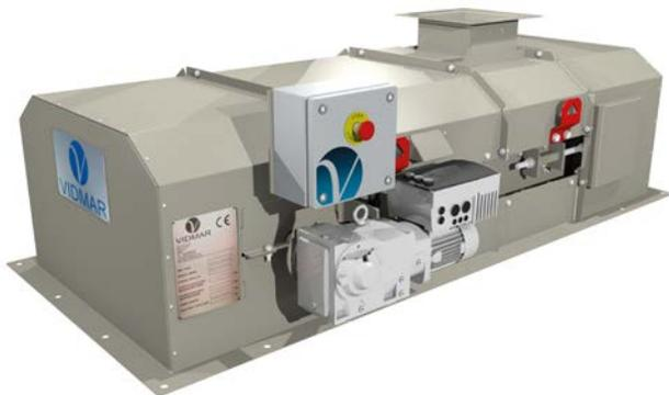
Vidmar fabrica y suministra equipos para el pesaje, dosificación, control, automatización y software industrial. Ha rediseñado una báscula dosificadora específica para la dosificación gravimétrica de productos granulados con temperaturas de hasta 200°C en continuo para trabajar en cargas bajas y con diseños específicos para la dosificación de combustibles alternos y productos de muy baja densidad.
