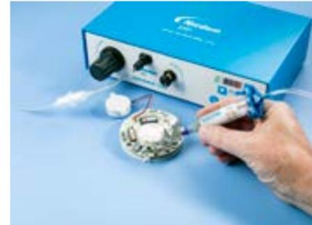
Ideales para administrar pegamento, aceite, grasa, epoxi, cianoacrilato, pasta de soldadura y otros líquidos de ensamblado mediante jeringas, los dispensadores de fluidos de mesa ofrecen un rendimiento confiable.
