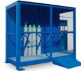
Los armarios y depósitos para botellas están concebidos para su instalación en exteriores y cumplen con los requisitos de la TRG 280 como almacenes de exterior. Indicados para almacenamiento de botellas de gas en el exterior cuentan con estructuras de perfiles de acero soldados y techo en chapa de acero cincado.
