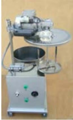
Permiten mantener en movimiento los barnices y colas a la temperatura propia antes de su utilización, evitando cualquier efecto indeseado como humedad, viscosidad, adherencia o granulosis debido a la baja temperatura.
