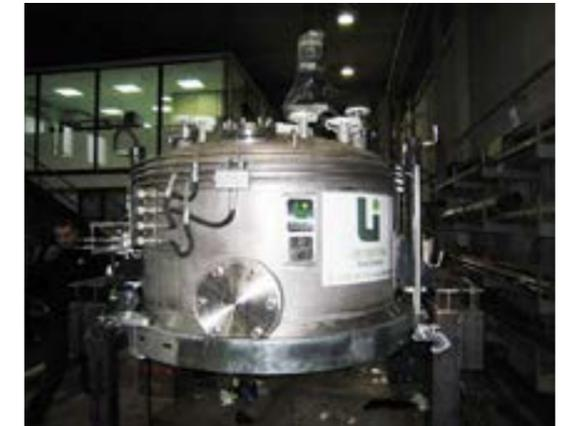
Los filtros nucha simples están pensados para realizar en un mismo equipo la alimentación, aplanado (pensado), filtrado, lavado, y vaciado de una suspensión líquido-sólido.
