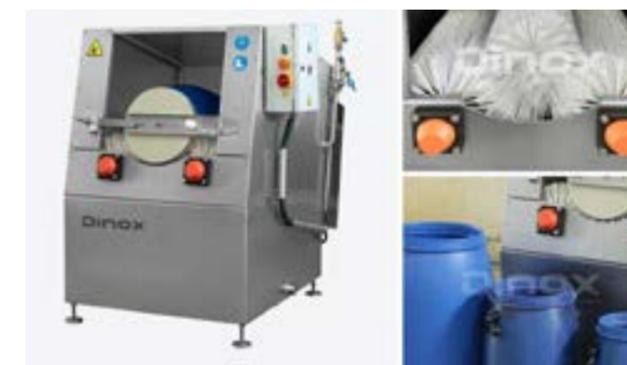
Este armario compacto para el lavado automático permite una producción de 60 bidones/hora. Realiza el lavado interior y exterior con cepillos e inyectores de agua. Los procesos del ciclo de lavado son programables, según las necesidades del cliente. Diferentes sistemas de calentamiento de agua. Elementos opcionales: dosificación de producto químico para mayor resultado higiénico, con bombas dosificadoras de alta eficiencia.
