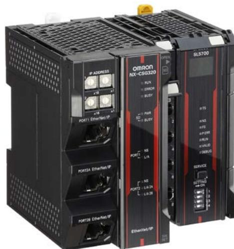
Omron ha anunciado la salida al mercado del controlador de red de seguridad de la serie NX, el primero que admite dos protocolos de seguridad: CIP Safety, muy popular entre los fabricantes de robots industriales, y Safety over EtherCAT (FSoE), que proporciona respuestas de alta velocidad.
