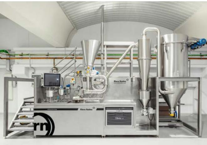
Los turbo secadores Rina-Jet, son secadores flash que permiten el secado instantáneo, automático y en continuo de sólidos húmedos, suspensiones y soluciones, combinando el efecto de turbulencia y vacío, con el desplazamiento a gran velocidad de partículas sólidas húmedas o dispersadas para obtener sólido seco y disgregado instantáneamente.
