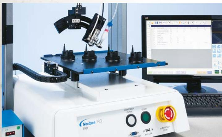
El robot Serie R con válvula de pulverización 781Mini aplica grasa sobre componentes de automoción.
