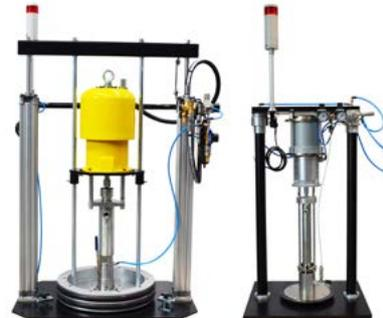
Bomba DTSPs - 110: la bomba Dtsps - 110 con una relación de respuesta 15:1, con tecnología de bomba de paleta, permite trabajar con depósitos originales desde 25 - 150 kg, elevador de doble columna que hace muy sencillas las funciones de carga y descarga de barril. Plato realizado a medida, junto con el pistón y cilindros fabricados en acero inoxidable endurecidos con cromas.
