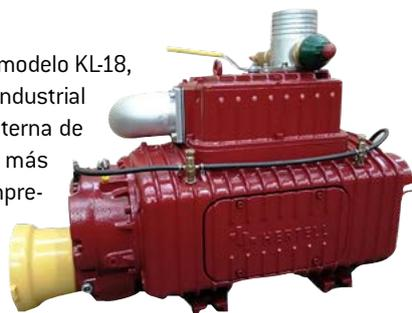
Se ha incrementado la cilindrada del depresor, creciendo el conjunto rotor/estator tanto en longitud como en el diámetro. Como particularidad, este modelo pasa de la trasera a la parte superior, lo que conlleva que el dúo distribuidor/macho cónico pasa a ser de mayor tamaño y que el primero de ellos tiene configuración doble.
