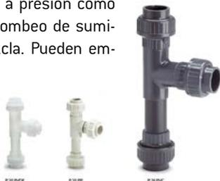
El principio básico de la bomba de chorro de agua es que el líquido propulsor emerge de una boquilla y arrastra el medio líquido o gaseoso fuera de la línea de succión, acelerándolo al mismo tiempo. El resultado de este proceso es una mezcla del medio propulsor y el medio arrastrado.
