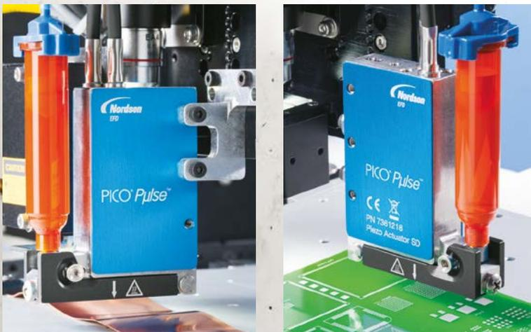
La válvula PICO® Pulse™ puede dispensar microdepósitos a partir de 0,5 nL.
