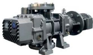
La velocidad de evacuación aumenta considerablemente en comparación con la bomba de vacío integrada en la máquina empaquetadora. El bypass integrado garantiza una alta seguridad operacional y alta disponibilidad para procesos de envasado de ciclo rápido.
