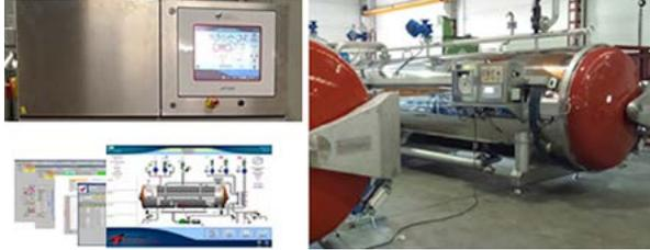
El sistema de control automático incluido en el autoclave Steribru ofrece condiciones de trabajo óptimas para la ejecución de procesos térmicos. Con una precisión de indicación de  $\pm 0,1$  °C /  $\pm 0,05$  bar y de regulación  $\pm 0,2$  °C.
