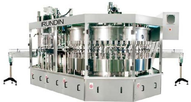
Irudin distribuye el sistema Monobloc 54-16 compuesto por una llenadora de 54 caños y una capsuladora de 16 cabezales. Con bancada de la máquina y chasis en Inox AISI 304, es de construcción muy robusta, garantizando un mínimo mantenimiento y gran fiabilidad.
