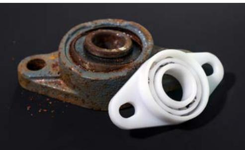
El resultado del test fue muy evidente. Al cabo de pocas horas, el rodamiento metálico empezó a mostrar los efectos de la corrosión. Al finalizar el test, también se observaron restos de oxidación en todas las partes de este rodamiento. En cambio, el rodamiento de plástico xiros permaneció intacto incluso después de 120 horas de contacto
