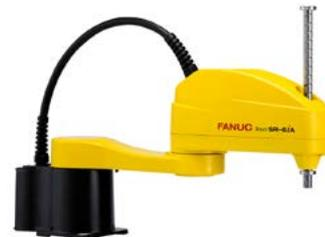
El ScaraSR-6iA ha sido diseñado para una alta productividad y ofrece un nivel excepcional de velocidad y precisión para las aplicaciones de ensamblaje y manipulación de materiales. El SR-6iA tiene una capacidad de carga de 6 kg, un alcance de 650 mm y un recorrido de 210 mm.
