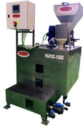
La capacidad de la tolva es de 60 l y su disposición permite añadir el polielectrolito en polvo sin necesidad de usar escalera. Estas plantas permiten 'bypassear' los depósitos para gastar todo el producto de la planta durante las paradas. Incorporan función de primer llenado.
