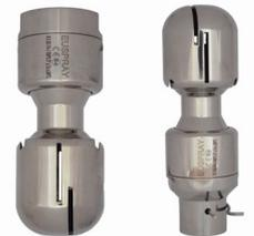
Las boquillas rotativas Eurospray, modelo LSD, están fabricadas en acero inoxidable AISI 316L. Están montadas con un doble rodamiento de bolas para tener una correcta rotación en cualquier posición de montaje. La parte giratoria tiene la peculiaridad de no tener líneas de acoplamiento y soldaduras. Son especialmente útiles en el sector alimentario y farmacéutico.
