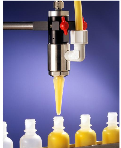
La válvula de pistón de alto flujo de la serie 725HF llena botellas pequeñas, paquetes de aluminio y otros envases con precisión absoluta hasta 450 ml por segundo.
