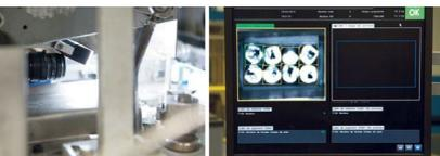
Bitmakers ofrece la serie CV-X, un sistema de visión de fácil configuración con enseñanza automática. CV-X realiza inspecciones avanzadas al alcance de todos, con sólo unos cuantos clics a través de menús interactivos.
