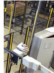
El exclusivo sistema X-Guard es un sistema de cerramientos para protección de maquinaria, que cumple los requisitos de protecciones fijas de la Directiva sobre maquinaria que entró en vigor en Diciembre de 2009.
