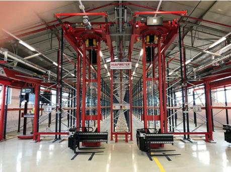
El Hubmaster es un equipo integrado de elevación y manipulación de cargas, bien sean paletizadas o no, que permite la gestión del almacén de un modo más seguro y sencillo para el operario. Se trata de una tecnología de movimiento y elevación de cargas que funciona suspendida del sistema de estanterías o directamente de la infraestructura del edificio
