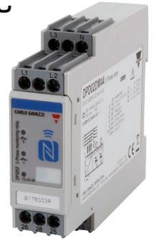
Carlo Gavazzi presenta la versión mejorada de los relés de monitorización trifásicos DPD con comunicación NFC. Los relés DPD son adecuados para todas las aplicaciones que requieren monitorizar la presencia de fase, secuencia de fase correcta, tensión, frecuencia y calidad de la red de cargas trifásicas: ascensores, escaleras mecánicas, climatización, manipulación de materiales, bombas y compresores.
