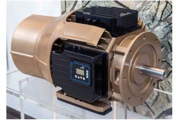
Este motor síncrono de reluctancia de 22 kW es un prototipo que presenta una tecnología de semiconductores que proporciona una gestión de la refrigeración para disipar el calor de la electrónica de potencia. Al integrar el variador de frecuencia en el motor, los desarrolladores reducen el volumen de la unidad en más del 25 por ciento en comparación con el diseño tradicional.
