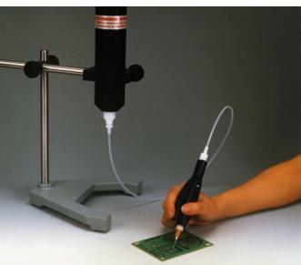
La válvula 710PT pinza-tubo de I&J Finar tiene la característica de conseguir un elevado grado de control con micro dosis o en aplicaciones en continuo, para fluidos de baja y media viscosidad.
