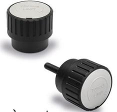
El pomo MZD incorpora un mecanismo (patente Elesa) por el que el operario puede realizar el apriete, girando el pomo en sentido horario, con toda seguridad, hasta que el pomo queda bloqueado, al alcanzar el valor de par requerido.
