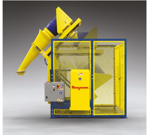
El volteador de tambores TIP-TIT para tambores de 115 a 200 litros presenta un cono de descarga alargado que se acopla con la entrada con empaques de recipientes receptores de baja altura, permitiendo la transferencia sin polvo de materiales sólidos a granel de flujo libre.
