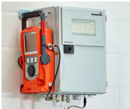
En la generación de biogás es muy importante el control del proceso mediante la medición de los gases generados. Este control no sólo permite multiplicar los beneficios de la explotación, sino también evitar grandes pérdidas.
