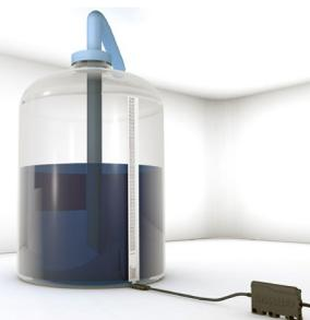
El cabezal de sensor flexible con un rango máximo de detección hasta de 850 mm de longitud se puede recortar individualmente a medida (mínimo 108 mm) y se puede fijar fácilmente a las paredes del contenedor sin accesorios adicionales usando la superficie adhesiva integrada. Para soluciones acuosas que sean polares, el grosor de la pared puede ser de entre 2 y 6 mm, o hasta de 2 mm para soluciones no conductoras como aceites o materiales a granel.
