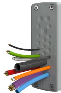
Los robustos marcos de poliamida están rellenos de elastómero y colocados en la parte exterior del armario o caja, y se fijan con tornillos en aberturas de 36 x 112 mm. Las placas tienen una altura de perfil bajo de tan solo 14 mm. También se pueden suministrar encajadas para permitir una instalación sin herramientas, en cuyo caso los agujeros de los tornillos quedan totalmente sellados gracias a la capa de elastómero.
