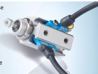
Es especialmente en lugares donde escasea el espacio donde el MZCG muestra su verdadera grandeza. Con una carcasa pequeña de 12,2 mm y una conexión radial del cable girada 90° es ideal para pequeños accionamientos. Un sistema de fijación patentado hace que la instalación sea rápida y segura: solo es necesario montar el sensor en la ranura en C mediante inserción directa (drop in) y fijarlo en el cilindro en un instante.
