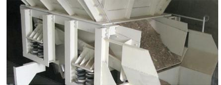
Alimentadores para diferentes materiales, tamaños máximos, granulometrías, grado de humedad, etc. La gama comprende alimentadores de tablero metálico, de banda, vibrantes, vaivén y conjunto alimentador-precibador.
