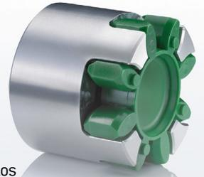
Los acoplamientos elásticos de estrella pueden amortiguar breves impactos de par gracias a la capacidad de almacenar temporalmente una parte de la energía que generan estos impactos, reduciendo de este modo el coeficiente de irregularidad de la transmisión del movimiento y de la fuerza. Los acoplamientos elásticos de estrella amortiguan el sonido estructural y, por consiguiente, ayudan a reducir los ruidos generados.
