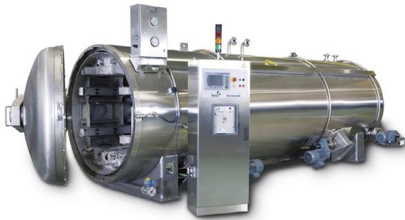
El autoclave rotativo de Ferlo basa su sistema de esterilización en el giro interno de la jaula donde se aloja el producto. Mediante el sistema de transmisión de calor y frío por medio de Spray.
