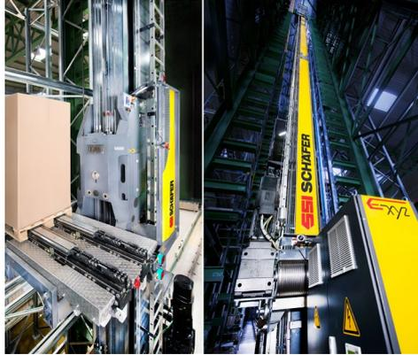
La designación Exyz representa todo aquello en los que destaca el transelevador. "E" de eficiencia con respecto al consumo energético y a la productividad, en las tres dimensiones de los ejes X, Y y Z: movimientos longitudinales y transversales, así como de almacenaje y desalmacenaje. Ante todo, Exyz se caracteriza por su construcción compacta, que promete beneficios para el cliente.
