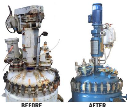
Revitrificar (Reglazing) es el proceso por el cual los equipos esmaltados viejos o dañados, se restauran a una condición de casi nuevos. Todos los reactores, tanques, columnas y accesorios en esmalte, tales como tapas, agitadores y rompecorrientes, se pueden revitrificar, si el sustrato de acero está en buenas condiciones o es reparable.
