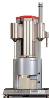
El Aflow ha sido diseñado especialmente para laboratorios con un gran volumen de probetas y se ha convertido en un símbolo de diseño robusto y cómodo manejo. El medidor de fluidez cumple todas las normas y procedimientos internacionales más comunes, tales como ISO 1133, ASTM D 1238.
