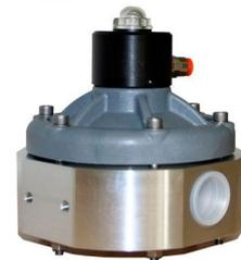
El acumulador hidráulico de ViscoTec es una solución muy simple para alcanzar una producción sin interrupciones cuando se necesita el cambio de envase (bidón, depósito presurizado, bomba de plato seguidor). El acumulador se integra entre la alimentación del producto que viene del depósito o bomba y la unidad dosificadora. Actúa como pequeño almacén intermedio.
