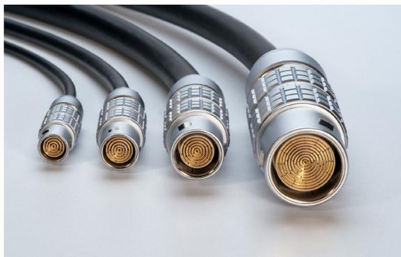
Los conectores multicontacto concéntricos de las series S y E de Iberlemo están ideados para instalaciones donde los conectores tienen que soportar cierta rotación como, por ejemplo, en los sistemas de perforación petrolífera en el fondo del pozo y en torreta. Estos conectores de precisión tienen entre 4 y 10 contactos eléctricos concéntricos y están disponibles en diferentes tamaños de cuerpo.
