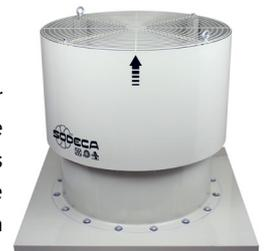
Permiten la evacuación de humos en caso de incendio de acuerdo a la norma EN-12101-3 con certificados F-400 (400°C/2h) o F-300 (300°C/2h). Además, cuentan con una base soporte en chapa de acero galvanizada y tratamiento anticorrosivo, compuerta antiretorno en chapa de aluminio para evitar la entrada de agua cuando el ventilador no está en funcionamiento, y rejilla de protección contra contactos según norma NE-EN ISO 12499.
