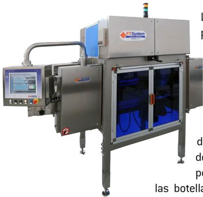
Los equipos de inspección IV1000 de FT System son apropiados para garantizar la calidad de los envases vacíos y reducir el número de atascos y descartes debidos a la presencia de contaminantes o imperfecciones/daños de las botellas vacías. El sistema permite la inspección completa de la botella con el objetivo de garantizar la conformidad y calidad antes de la fase de llenado.
