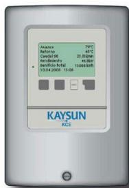
KCE: contador de energía que incluye multisensor para caudal (2-40 l/min) y temperatura del retorno (0-100 °C) para la cuantificación de la energía por la temperatura de la ida y del retorno y por el caudal del sistema.
