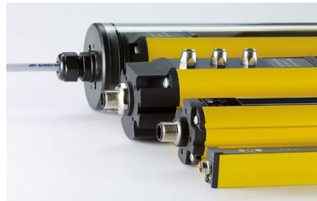
En su caja de perfil de aluminio de 12 x 20 mm, la serie SLC 430 de cortinas de seguridad puede ser integrada en construcciones en los cuales el espacio es extremadamente limitado. A parte de su tamaño, estas cortinas cumplen con todos los requisitos de seguridad y ofrecen un manejo cómodo. El usuario se beneficia de seguridad y confort, tal como relé de seguridad y arranque/rearranque integrado. Un led indica el modo de operación del SLC 430.
