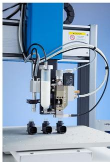
Nordson EFD presenta una serie de sistemas dosificadores neumáticos sin contacto. Las válvulas P-Jet y P-Dot y los controladores V100 bombean fluidos de baja y alta viscosidad con gran precisión y repetición. Están diseñadas para ser utilizadas en diversos tipos de aplicaciones y múltiples industrias, incluyendo la industria automotriz, electrónica, aeroespacial y médica.
