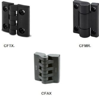
Las bisagras CFMR están especialmente desarrolladas para su uso cuando se necesita un cierre inmediato de la puerta de equipo o máquina. El cierre se realiza mediante un muelle interior de acero inoxidable, y su funcionamiento en tests realizados, en laboratorios de calidad, superan los 100.000 ciclos de uso, con todas sus cualidades intactas y sin variar los valores del par.
