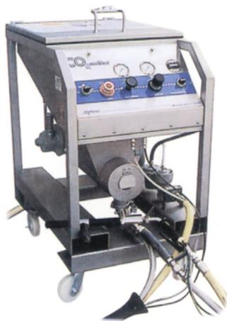
El sistema CO<sub>2</sub> Cleanblast de Air Liquide es un método ecológico de limpieza de superficies por proyección de CO<sub>2</sub>.
