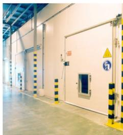
Equipada de serie con un rail de acero inoxidable, porta-poleas en acero inoxidable, cantoneras de la hoja en acero inoxidable y un aislamiento interior de 120 mm en poliuretano de alta densidad de 50kg/m<sup>3</sup>. Equipado de serie con un ventanillo de control de 600 x 800 mm en aluminio (opcional: en inoxidable).
