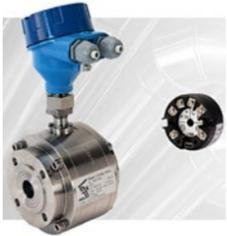
El transmisor de caudal DFD420 es un convertidor pulsos / corriente que se adapta tanto a los caudalímetros de pistón oscilante de la serie COVOL y turbinas serie TM de Tecfluid S.A. como a otros emisores de pulsos del mercado. Dispone de dos salidas. Una analógica en forma de bucle de corriente a dos hilos, que a su vez alimenta el equipo, y otra aislada que proporciona pulsos proporcionales a los pulsos de entrada o una alarma configurable.
