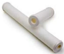
El Filtro en profundidad HC tiene una estructura de múltiples capas de microfibras de polipropileno de porosidad asimétrica con las que se consigue aumentar la capacidad de retención de impurezas y alargar su vida.
