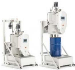
paración de materiales en bidones más pequeños (tecnología A310). Así, permite realizar el vacío, favoreciendo la protección del material de la humedad del entorno y su desgasificación.
