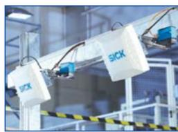
Estas soluciones son estáticas y dinámicas para procesos de entrada de mercancías manuales y automatizadas. En ellas se utilizan tecnologías modernas como lectores de códigos de barras, RFID, cámaras de visión y tecnología de medición láser pluridimensional para la identificación de los objetos, así como para determinar geometrías, contornos, salientes y pesos.
