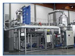
MFE-2 (30.000-120.000), un evaporador al vacío de dos etapas cuyo sistema brinda dos alternativas de calentamiento para evaporación del primer efecto; un intercambiador tubular con circuito de vapor y otro con circuito de agua caliente; así como otras dos alternativas de condensación en el segundo efecto: un equipo Air condenser (AC) e un intercambiador de placas con circuito de agua de refrigeración.
