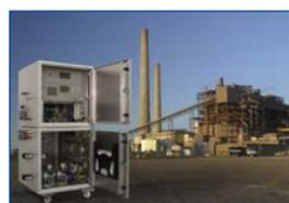
Idóneo para diferentes puntos de medición, el SM4 mobile de Mercury Instruments se ha desarrollado a partir del monitor de gas de combustión SM-4. Su principio de funcionamiento, su reactivo termocatalítico, el detector y la sonda de muestreo son idénticos a
