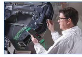
DataPaq lanza su nuevo registrador de temperatura AutoPaq, un dispositivo capaz de admitir conexiones de hasta 20 termopares y por tanto realizar perfiles térmicos hasta el más mínimo detalle para procesos de curado de pintura, adhesivos y sellantes en automoción.
