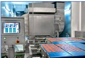
buidas Allen-Bradley Point I/O™ y, para los interfaces de operación, Allen-Bradley PanelView™ HMIs y FactoryTalk® View Site Edition (SE).
