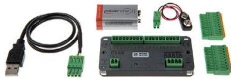
tan con protección integrada en todos los I/Os, resistencia a los golpes, a la vibración y al sellado IP20, asegurando su fiabilidad en entornos difíciles. Además, su capacidad de programación gráfica hace de estos mini PLC un elemento práctico y fácil de usar. El paquete de programación miCon-L reúne los estándares de los últimos lenguajes de programación gráfica, integrando capacidad de test y simulación.
