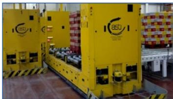
culo esté equipado con fotocélulas que aseguran la óptima recogida, transporte y depósito de la misma. Complementariamente cuenta con un sistema de aviso tanto acústico como luminoso.
