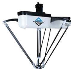
trabajar en el entorno adecuado en función de sus capacidades o necesidades. Los sensores externos son compatibles con buses de campo estándar (EtherCAT, Modbus TCP, Ethernet/IP™ y otros) o programas que funcionan en el sistema operativo Windows® habilitado para tiempo real del RCP-DELTA.
