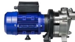
Las bocas de aspiración y descarga van fundidas como una sola pieza con una selección de materiales de acero inoxidable 1.4308 (Comeo C) o de fundición gris JL 1040 (Comeo G). Dependiendo de la presión de descarga requerida, las bombas van equipadas con dos, cuatro o seis etapas. Su robusto diseño compacto absorbe las fuerzas externas de la tubería y es adecuado para montaje en espacios muy reducidos.
