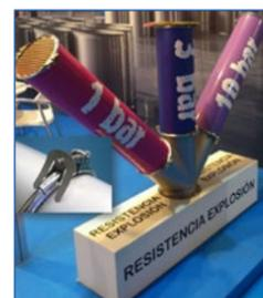
Una característica importante a la hora de evitar riesgos de explosión es conducir la carga estática de un tubo al otro, esto se realiza mediante un "clip" colocado en la unión de los dos tubos y debe tener contacto entre un tubo y otro para asegurar la conducción.
