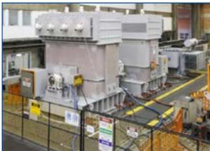
múltiples soluciones para accionar grandes molinos, incluyendo motores de baja y alta velocidad, reductores y variadores de frecuencia. Debido a la complejidad y los costes, los equipos se suelen probar individualmente. No obstante, para este importante proyecto, se ha probado el conjunto como sistema completo antes del envío, para garantizar su fiabilidad según los requisitos de la aplicación.
