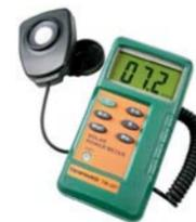
la piel. Admite función de retención y recuperación de datos, valor máximo y mínimo, establecimiento del punto decimal, ajuste de cero, cambio de escala e indicador de batería débil. Se alimenta mediante Pila 9V, (NEDA 1604, IEC 6F22, JIS006P), con una autonomía aproximada de 100 h.
