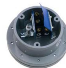
Estos controladores de nivel para líquidos se componen de un microrruptor accionado por una membrana sensible a la presión. La conmutación del microrruptor se obtiene por la compresión de la columna de aire que queda cautivo en el interior del tubo al ascender el líquido en el depósito. Además de líquidos, se puede controlar cualquier mezcla lo suficiente fluida como para que al vaciarse el depósito deje limpio el interior del tubo.
