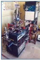
El Laboratorio de Bajas Presiones del Instituto de Óptica "Daza de Valdés" - CSIC se dedica al desarrollo y la aplicación de dispositivos y sistemas que trabajan en condiciones de vacío. El vacío se define como aquel ambiente cuya presión absoluta es inferior a la presión atmosférica. En el Laboratorio se cubre el rango de presión absoluta desde 1E-8 Pa (1E-10[ultraalto vacío] hasta 90 kPa (900 mbar) [vacío bajo].
