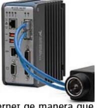
El CVS-1457RT cuenta también con E/S basadas en FPGA, las cuales se pueden combinar con la fácil de usar API de Visión RIO para sincronizar perfectamente los resultados de la inspección visual con otras partes del sistema, tales como codificadores, eyectores y sensores de proximidad. El CVS-1457RT se puede programar, ya sea con el software de diseño de sistemas NI LabVIEW o con NI Vision Builder para inspecciones automatizadas (AI).
