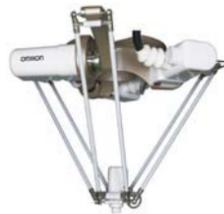
El robot DELTA IP67 dispone de 3 ó 4 ejes, que permiten un movimiento en XYZ, -más una rotación en el caso del modelo con cuatro ejes-, pudiendo ser éste de alta o baja inercia para adaptarse a los requerimientos de la aplicación y conseguir el aumento de producción esperado por el cliente.
