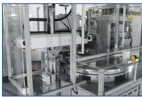
El pórtico High-Speed en T y el trípode de Festo son un 30% más rápidos que los sistemas de manipulación convencionales. Festo entrega los sistemas listos para montar directamente en la máquina y adaptados a todas las interfaces necesarias.
