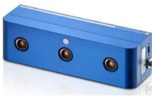
La cámara Enseno N10 funciona con el sistema "Projected Texture Stereo Vision" e integra dos sensores CMOS Global Shutter y un proyector que genera un patrón de puntos aleatorio sobre el objeto cuya imagen se desea captar. La
