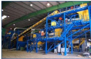
La empresa LIMASA ha instalado tres separadores ópticos TITECH autosort 4 en su Planta de Clasificación de Envases del Centro Ambiental de Málaga "Los Ruices". Los equipos de TITECH separan las diferentes fracciones
