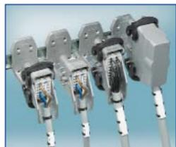
Su resistente estructura de fundición inyectada de aluminio lo convierte en el sistema que mayor estabilidad ofrece para la conexión de un robusto conector industrial sobre carril. Es por ello, además, el único en ofrecer una conexión directa y en avance de PE según norma UL1977. Su diseño en U permite utilizar fácilmente soportes de contacto ya confeccionados.
