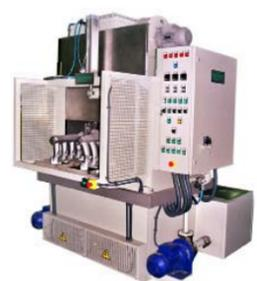
La carga y descarga se realiza desde el frontal de la máquina, colocando las piezas en una cesta o en un carro soporte, cuando se trate de cargas muy elevadas.
