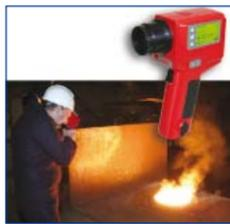
Medir la temperatura del metal fundido es un proceso lento y discontinuo. El uso de termopares puede ser caro y peligroso. El nuevo Cyclops 055 Meltmaster es rápido y preciso, fácil de utilizar y sin contacto con el metal líquido.
