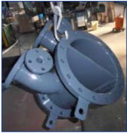
Los recubrimientos plásticos son una alternativa a los acabados convencionales y aportan a las piezas metálicas unas características muy especiales: aislamiento eléctrico, anticorrosión, flexibilidad, contacto alimentario, etc.
