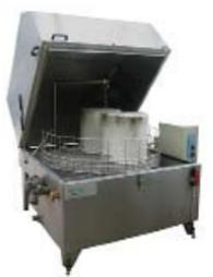
Su gran capacidad de carga permite lavar simultáneamente varios tipos de piezas. Las piezas se colocan en el interior de una cesta giratoria que permite el lavado de toda su superficie, gracias a los chorros a presión de agua caliente con detergente que están dispuestos en la parte superior, inferior y lateral de la máquina, la cual está construida enteramente en acero inoxidable.
