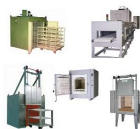
De construcción sólida y bien aislados, tienen un bajo consumo energético, son de gran robustez para poder trabajar en continuo y su regulación es siempre automática. Se fabrican en diferentes modelos y estos pueden ser: Estáticos, continuos, lineales, rotativos.
