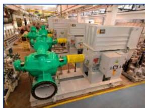
Se trata de once motores de inducción trifásicos indicados para atmósferas explosivas, los cuales se emplearán para accionar las bombas centrífugas, que suministran el agua a las torres de refrigeración de las turbinas de vapor principales de la refinería Petrobras de Abreu e Lima, en Pernambuco.
