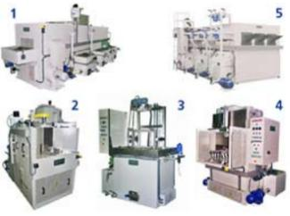
Se trata de máquinas automáticas especiales para el desengrase, el lavado y secado de diferentes tipos de piezas mecanizadas a fin de conseguir el máximo grado de limpieza, garantizándolo mediante exigentes pruebas de laboratorio, obteniendo excelentes resultados tanto en el
