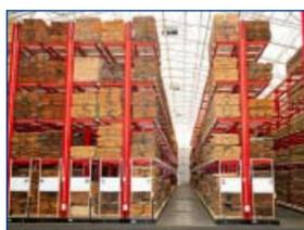
La empresa Hechenblaickner, firma destacada del sector de la madera en el sur de Austria, ha duplicado la capacidad de su almacén central de Graz gracias a las estanterías cantilever de Ohra. Para ello, las estanterías se montaron sobre carros móviles y únicamente se abre para la carretilla
