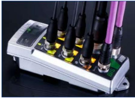
El RFID industrial BIS V de Balluff, permite realizar una rápida comunicación de datos sin contacto de forma más eficaz, ya que solo combina el RFID con los sensores. BIS V - el sistema variable e inteligente
