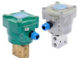
y EPL. Ambos operadores cumplen con la aprobación IECEx y están certificados conforme a la IEC 61508 Functional Safety (Nivel SIL 3). Consumen solo 0.5W a 24VDC y constan de bobina amplificada electrónicamente, de reciente desarrollo, y núcleo de acero inoxidable. Las versiones con capot de Aluminio con recubrimiento epoxy o AISI 316L son IP66/ IP67. La cabeza se puede girar 360°.
