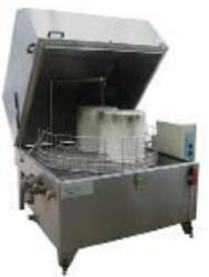
Su gran capacidad de carga permite lavar simultáneamente varios tipos de piezas. Las piezas se colocan en el interior de una cesta giratoria que permite el lavado de toda su superficie, gracias a los chorros a presión de agua caliente con detergente que están dispuestos en la parte superior, inferior y lateral de la máquina, la cual está construida enteramente en acero inoxidable.
