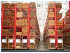
La empresa Hechenblaickner, firma destacada del sector de la madera en el sur de Austria, ha duplicado la capacidad de su almacén central de Graz gracias a las estanterías cantilever de Ohra. Para ello, las estanterías se montaron sobre carros móviles y únicamente se abre para la carretilla
