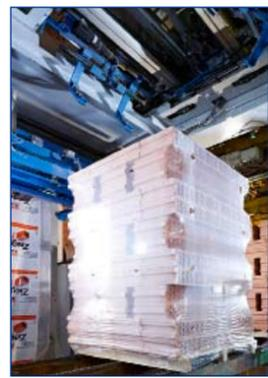
Gracias a las propiedades altamente flexibles de la hoja, ésta puede extenderse sobre la carga paletizada completa y después contraerse para el estirado inferior. Esto facilita una mejor unión. La instalación tiene un rendimiento máximo de 110 paletas a la hora, en la planta del fabricante de materiales de construcción realiza 80 paletas.
