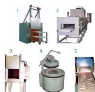
cos o fusión. En el mercado existe una amplia gama de hornos con cámaras circulares en donde pueden alojarse cestas con bandejas o soportes de carga para calentamientos diversos de estabilizado, revenido y demás tratamientos térmicos, con recirculación forzada o atmósferas de protección y vacío... O bien pueden equiparse con crisoles para fundir metales.
