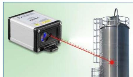
tanto si está seco o tiene una gran humedad, no importa ni color ni textura. Puede medir el nivel en un silo o canal hasta una distancia de 30 metros. El sensor EDS-C es robusto, montado en caja de aluminio, el grado de protección es IP65, conector M12 y salida analógica programable de 4-20 mA.
