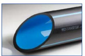
El nuevo ECO-SIS® WATER SLIDE multicapa está fabricado en PE-RC según las medidas establecidas en las normas europeas EN 12201, EN 13244, ISO 4427 y DIN PAS 1075 con dos tipos de materia prima, una externa negra con bandas azules y una interna de color azul.
