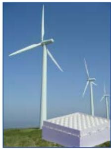
los lugares más remotos, pudiéndose controlar el equipo de forma local o remota, vía GPRS o con receptor/transmisor satélite. Por otro lado, reduce los riesgos laborales al no trabajar en altura y estar situado a pie de campo. Los sistemas láser Lidar, también para monitorización remota, emiten pulsos ópticos y analizan la señal recibida, obteniendo medidas de perfiles de viento con un alcance superior a los sistemas
