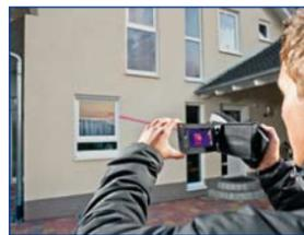
Ésta se encarga de reconocer automáticamente el lugar de medición, almacenar y administrar las termografías tomadas. Además permite la posibilidad de realizar mediciones en rangos de temperatura de hasta 1.200°C. Testo AG ofrece soluciones de medición para, entre otras cosas, climatización, medio ambiente, aplicaciones industriales, emisiones, control de calidad de alimentos y para el sector de la construcción.
