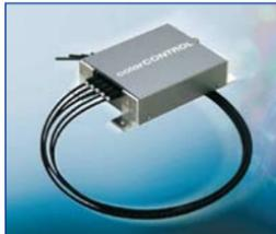
La luz reflejada del objeto se transmite a través de fibra óptica flexible de plástico de 2 mm.de diámetro al Sensor, para evaluar su color e intensidad. El valor del Color calculado en milisegundos, tiene cómo salida sistemas de emisiones RGB, HSI o CIE que luego se traducen a interfaces USB o RS232; cuyas respuestas pueden oscilar entre 9600 y 115200 Baudios. Según queramos una u otra, a la hora de La Inspección, un sistema superior de control; o para una evaluación posterior.
