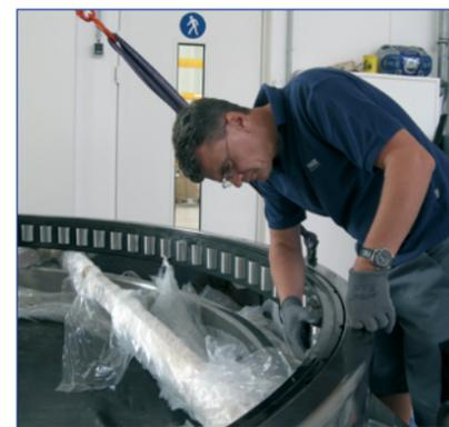
miento especial de NKE. El rodamiento de rodillos cilíndricos de diseño especial con jaula maciza en acero tiene un diámetro exterior de 3,3 m, un diámetro interior de 2,9 m y un peso de 2,2 toneladas. El rodamiento de dimensiones grandes es cargado con una fuerza de apoyo de 76,3 toneladas, la velocidad es de 125 rev/min, la masa en rotación es de aproximadamente 200 toneladas. La lubricación por
