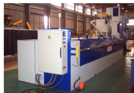
Roller Blaster RCP es una máquina automática, especialmente diseñada para el granallado exterior de tubos, rodillos, o cilindros, mediante proyección de abrasivo por aire comprimido, permitiendo controlar la zona de tratamiento, la rugosidad y el anclaje de la pieza.
