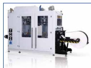
en la bobina, en combinación con la soldadura de esquinas realizada por la ensacadora dan como resultado un acabado impecable del saco lleno, de tipo paralelepípedo (las esquinas quedan verticales al no poder el producto introducirse en ellas) lo que repercute también en un palet en perfectas condiciones
