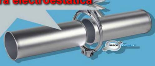
Tubería Metálica Modular. Nuevo Catálogo 2011. Soporta 3bar en estándar. Certificación para 10bar. Montaje sin necesidad de herramientas. Soldadura robotizada en láser. Desde DN60 a DN800. Construcciones especiales bajo pedido. La gama más amplia de accesorios.
