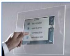
El monitor LCD, de grandes dimensiones, y la interfaz intuitiva gráfica de hejTouch permiten dar órdenes al sistema hej de manera sencilla y rápida: con un sólo toque, es posible abrir la cancela, regular luces, levantar toldos y persianas, activar la instalación de riego e interactuar con el sistema antirrobo y sobre todo, activar y desactivar escenarios preprogramados.
