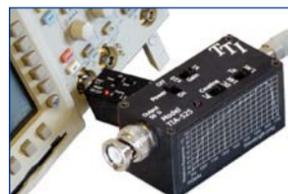
La gama TIA de convertidores O/E de Terahertz está compuesta por un amplio conjunto de modelos que van desde DC hasta los 20GHz con longitudes de onda de 400nm a 1700nm. Según los modelos utilizan conectores BNC o hembra K SMA.
