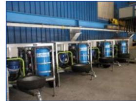
tración para dejar el agua exenta de sólidos y microorganismos de tamaño mayor a 150 K Dalton. A la salida se produce una desinfección final del agua tratada mediante una limpieza de rayos ultravioletas (UV) Para complementar la desinfección, después del UV se dosifica hipoclorito como
