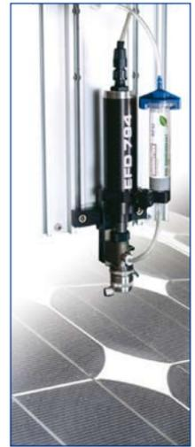
Con el objeto de dosificar cantidades precisas y repetitivas de materiales mezclados con partículas (como soldaduras en pasta y epoxis de plata), la válvula 794 de barrena que nos presenta EFD International utiliza el principio de alimentación por efecto de tornillo, combinado con un preciso control de tiempo y presión.
