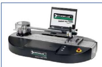
resulten dañados tanto las llaves dinamométricas como los captadores de valores medidos. El cambio rápido y sencillo de los captadores de valores medidos por medio de QuickRelease permite calibrar las más diversas herramientas.
