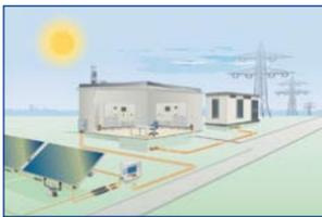
Las principales exigencias de SMA en el diseño de este cable fueron flexibilidad y durabilidad. Además de poder soportar la intensidad requerida, ÖLFLEX® TRAF0 se ha diseñado para poder ser enterrado directamente, con una cubierta exterior reforzada. Esta cubierta se compone de copolímero reticulado por haz de electrones, altamente resistente a rayos UV, ozono y resistente frente a condiciones ambientales rigurosas.
