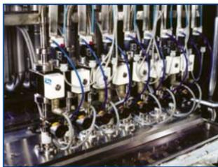
Como elemento integrado en la máquina llenadora, los módulos de dosificación de Mabeconta garantizan el funcionamiento de la dosificación. Cuentan con medidores magnético-inductivos, así como función automática incorporada.
