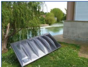
OKSOL-150 es un SISTEMA solar integrado que utiliza la tecnología solar térmica para la producción de Agua Caliente Sanitaria. En un solo elemento integra el absorbedor, el sistema de recirculación forzado y el acumulador de ACS de 150 litros de agua. Utiliza la tecnología solar fotovoltaica para alimentación de la bomba de recirculación® lo que lleva a que sea un sistema totalmente autónomo sin necesidad de ninguna fuente de energía exterior.
