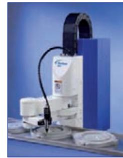
lita la integración del brazo dosificador a sistemas de transferencia en línea, mesas rotatorias y soluciones de paletización. La unidad se instala fácilmente y es fácil de usar, dejando tiempo libre para asignar a otros proyectos, a la vez de incrementar la productividad del proceso.
