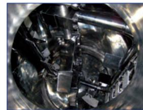
Link Industrial presenta sus agitadores coaxiales. Estos equipos están diseñados especialmente para productos viscosos ya sean cremas, pastas, etc. Permite en un solo equipo un movimiento lento, mediante un ánora, (con o sin rascadores) y un agitación más rápida en contrarrotación con turbinas. Puede suministrarse con un micronizador de fondo para emulsionar y/o dispersar la mezcla. Opcionalmente se puede suministrar el sistema hidráulico del fondo.
