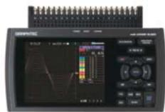
El registrador Grphtec 820, de 20 canales aislados que permiten diferente tipos de entrada, Voltaje de 20mV a 50V, Temperatura (termopares y RTDs), Humedad, Lógicas, Pulso, y pueden ser ampliados hasta 200 canales mediante módulos de 20canales cada uno.
