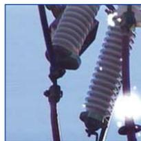
La corona es una descarga luminosa debido a la ionización del aire. Causa el deterioro del aislamiento y en consecuencia los fallos en componentes son más probables.
