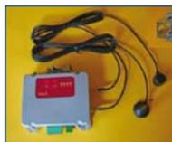
A diferencia de un módem GSM standard, el ICS dispone de una serie de prestaciones que le dotan de la robustez necesaria para trabajar en entornos industriales complejos donde un módem GSM standard no podría asegurar la fiabilidad necesaria.
