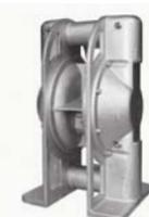
Tapflo está aumentando la capacidad de las bombas de metal de la serie T con el lanzamiento de la nueva TX 820, una bomba de membrana accionada por aire comprimido fabricada en aluminio. Esta bomba consigue una capacidad de hasta 820 litros por minuto, ha sido aprobada con certificación ATEX, y por lo tanto es adecuada para entornos explosivos.
