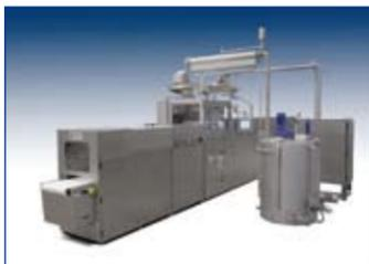
CANopen para la maniobra con los módulos de entradas salidas distribuidos OTBs, el control de los variadores de velocidad ATV31 y los LID (Lexium Integrated Drives) ILS de la válvula dosificadora. Motion Bus, como bus síncrono, permite controlar en posición aquellos ejes que lo requieran (dosificadores) y sincronizar el movimiento de dos o más ejes (carro, línea).
