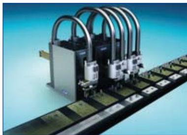
En la solución que ofrece SCHUNK, los cables eléctricos, de control y los sensores se conectan al instante en la parte posterior. De esta manera se descartan casi por completo las roturas de cables y los posibles fallos del sistema. Además, la forma estrecha de la carcasa así como el hecho de que los pases de fluidos estén en un panel trasero compacto, facilita
