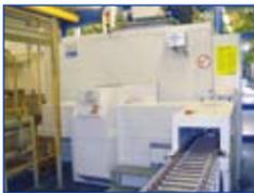
Antes de cada ciclo de relleno, un sistema automático comprueba la estanqueidad de la puerta de la cámara de trabajo, lo que garantiza un alto nivel de seguridad. El sistema de limpieza por inundación puede ser ampliado por la aplicación de ultrasonidos. El proceso
