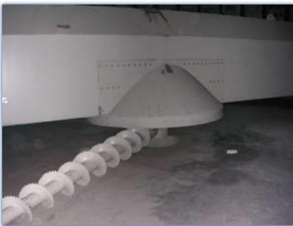
Son el complemento ideal para los silos SG, con este equipo podemos extraer cualquier producto ensilado, por difícil que sea: Biomasa, Neumáticos Triturados, Astillas de madera, etc. Y obviamente cualquier tipo de material en polvo o granulo.
