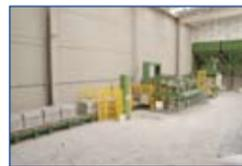
el sistema de cierre de las mordazas en las ensacadoras de lámina, por medio de un motor eléctrico y gestionado por inverter. En el proceso de paletización, en los modelos Maxipal Speed, se ha modificado el preformador de capas con rodillos por un preformador por bandas. En el sobreembalaje, adaptando un nuevo modelo para palets con peso no superior a 1.200kg, sin olvidar, la continua mejora en la gestión y respuesta en el servicio postventa.
