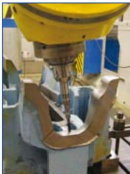
La técnica de amarre por deformación, desarrollada y comercializada por Schunk bajo el nombre de TRIBOS, permite la sujeción de herramientas a través de la deformación de material dentro de sus límites de elasticidad.
