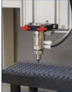
La válvula 784S-SS incorpora la probada tecnología EFD de pulverización de Bajo Volumen a Baja presión (en Inglés denominado con las siglas LVLP), que reduce rápidamente los costes de producción, controlando la aplicación del fluido sin desperdicios y sin sobre pulverización. En lugar de una boquilla estándar de pulverización, el fluido
