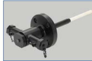
Emerson Process Management presenta el nuevo termopar Rosemount® con tubo protector de zafiro para aplicaciones en reactores de gasificación, especialmente desarrollado para dar una mayor vida operativa en condiciones de proceso difíciles, donde las temperaturas se elevan hasta los 1800°, las presiones hasta 110 bar y se encuentran presentes gases agresivos, provocando fallos prematuros de los termopares estándar.
