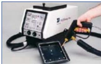
Dotest ofrece un equipo dosificador de Hot Melt eléctrico capaz de controlar la Temperatura de fusión del termoplástico y el volumen a dispensar en aplicaciones industriales que utilicen productos tales como resinas termofusibles, colas de contacto, ceras o sellantes todos ellos licuados a diferentes temperaturas de fusión.
